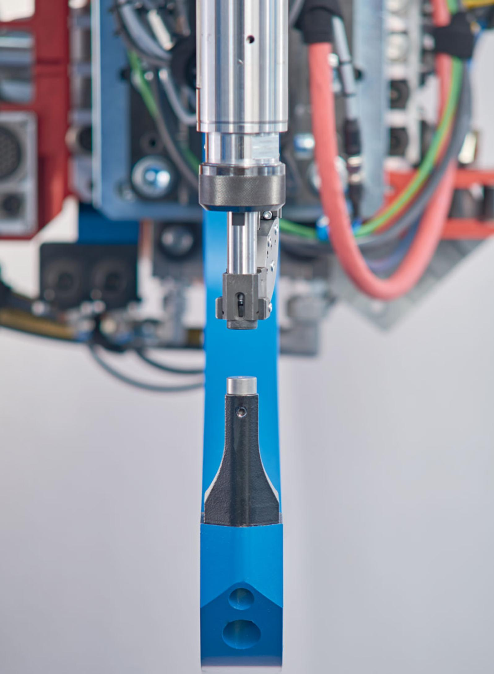
Unser Widerstandselementschweißen WELTAC® setzt auf unser bewährtes Verarbeitungssystem RIVSET® Automation EH. Dieses ist unter anderem durch den modularen Aufbau für Applikationen in der Großserienproduktion mit maximaler Flexibilität in der Fertigungsplanung prädestiniert.
